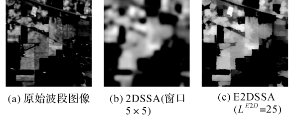
图 3 2D-SSA 和 E2D-SSA 的空间特征提取效果 Fig.3 Effect of spatial feature extraction for 2D-SSA and E2D-SSA
