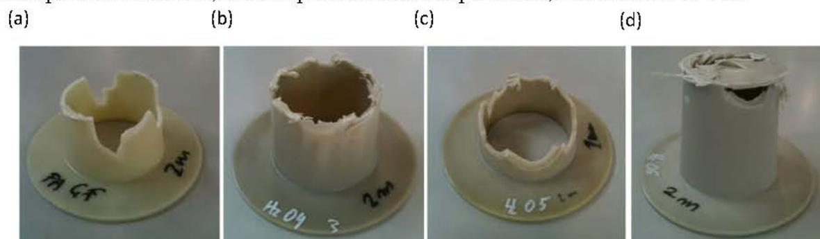
**Figure 2:** Dynamic collapse mode of PA6 composites (a) PA/GF (b) PA/GF/SiO<sub>2</sub> (c) PA/GF/MMT (d) PA/GF/GS
