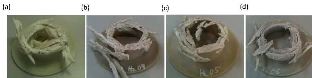
**Figure 3:** Static collapse mode of PA6 composites (a) PA/GF (b) PA/GF/SiO<sub>2</sub> (c) PA/GF/MMT (d) PA/GF/GS.
