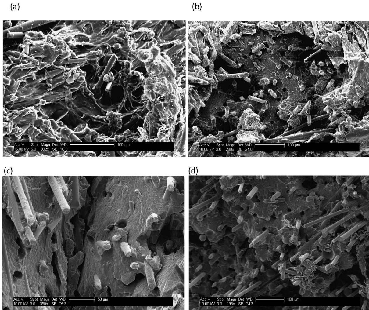
**Figure 4:** PA composites: (a) neat, (b) SiO<sub>2</sub>, (C) MMT and (d) GS.
