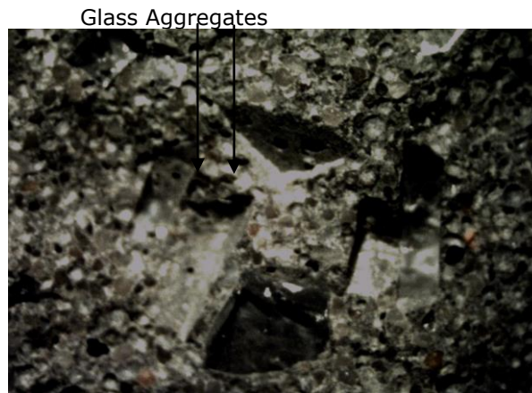
(d) BB2: 80g 4-2 mm Glass Aggregates
